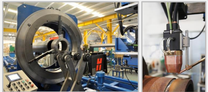
D-TIG Cladding on Pipe ID
